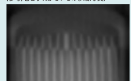
(参考)巻きずれがないもの(X線写真)
