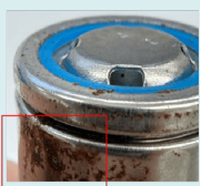
電池表面に錆を確認
