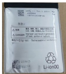
85℃で検証したバッテリー（1～2mmの膨張を確認）
