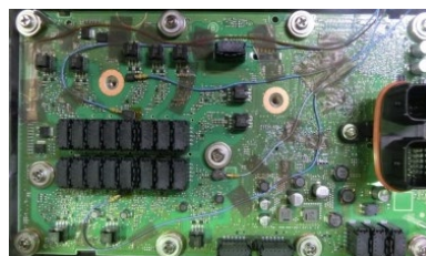
図1 パワーコントロールユニット制御基板(4世代プリウス)。振動試験のためのセンサーが配置されている。(注意:この基板設計にはブラックボックス最適化を用いていない)
