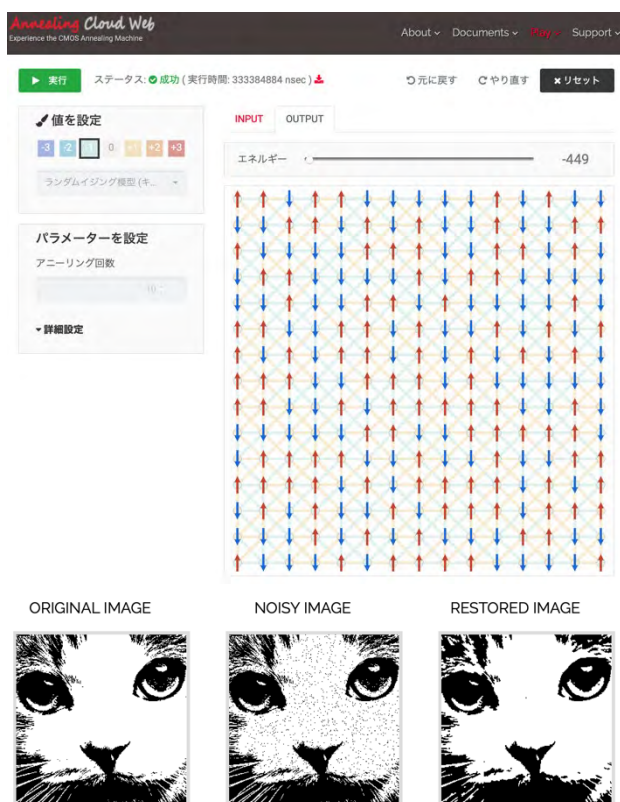
図 2 : Annealing-Cloud Web 15) におけるイジングエディタ (上) と、画像のノイズリダクションのデモンストレーション (下)。
