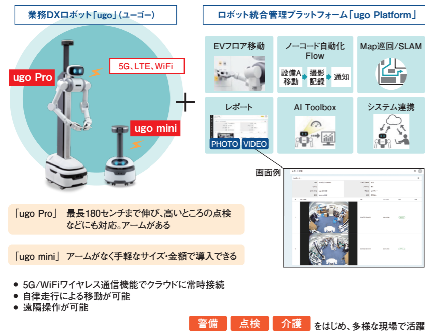
図1 人と協働し、現場の業務を最適化するロボット「ugo」の構成
