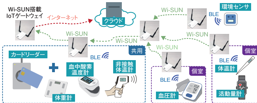
図 IoT (Wi-SUN 通信搭載機器) による高齢者施設の健康・見守りシステム
