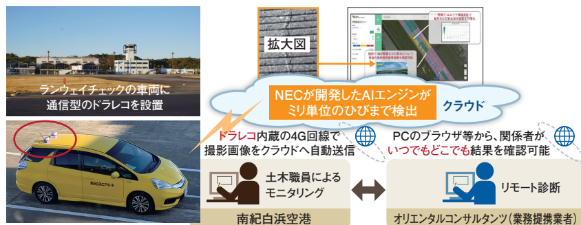
図 「ドライブレコーダーとAI」を活用した空港滑走路診断
