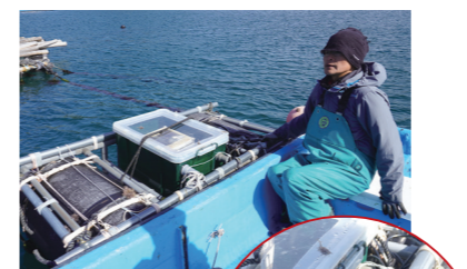
海洋データを取得するための設備。電気はソーラーパネルを活用
