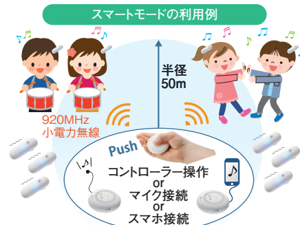
半径50m以内なら台数制限なくAntenna本体を同時制御できる
