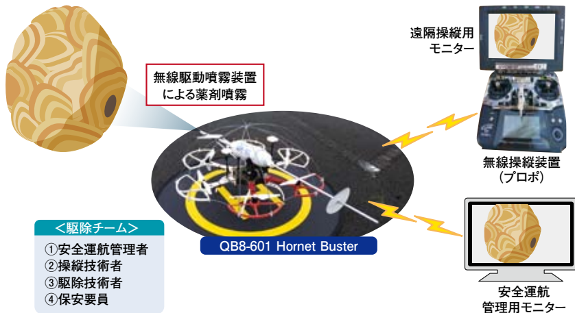
図 小型無人航空機(ドローン)による「スズメバチの巣」駆除システム
