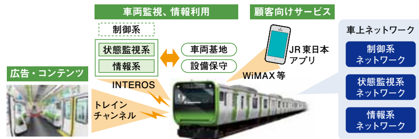
図 新型通勤電車E235系のネットワーク
