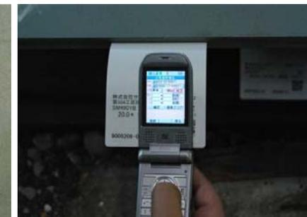
使用する鋼板のQRコードを読み取り、作業内容を登録します。
